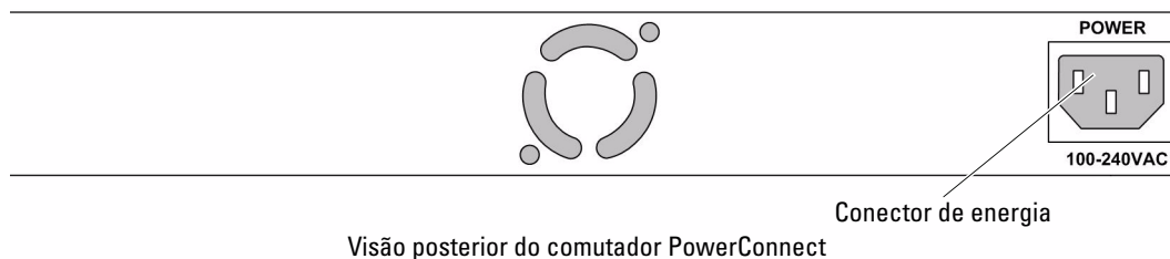
Figura 1-4. Conectores de energia do painel posterior
